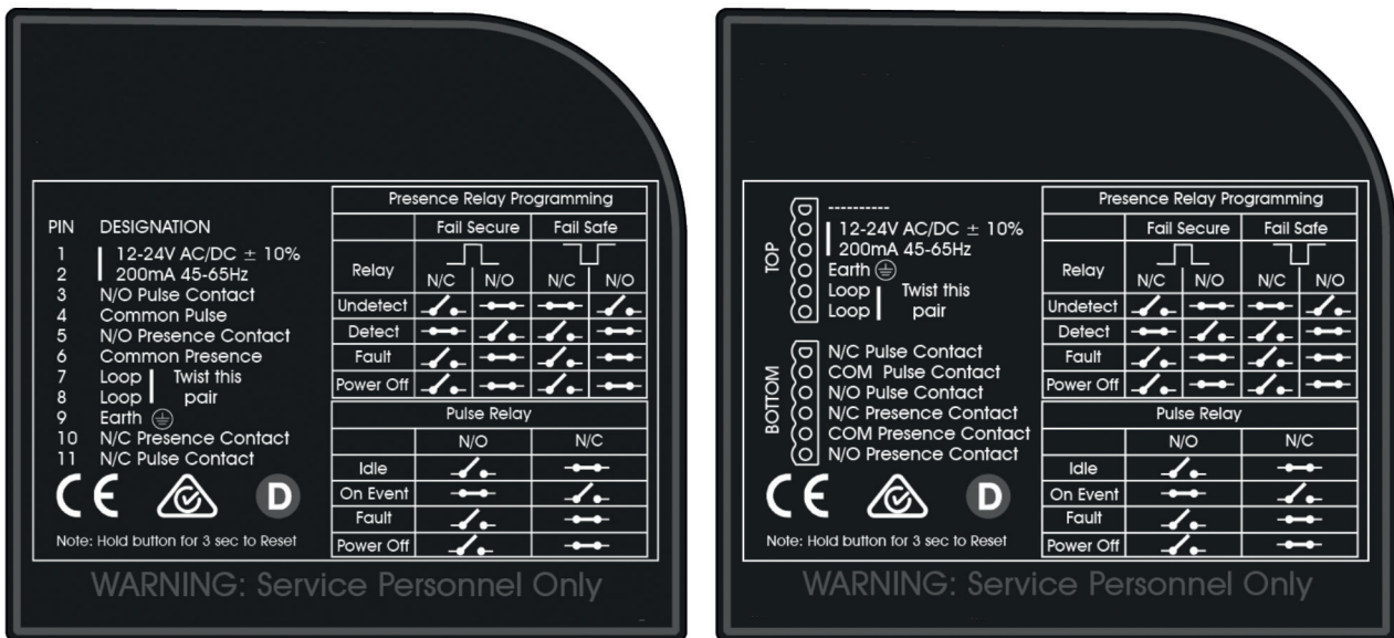
Bild 8. Beispiel eines LC20-1-Typenschildes. Die Stromversorgungsanforderungen und Polverbindungen sind an der Geräteseite deutlich angegeben. Die 11-polige Konfiguration wird links gezeigt, und die DIN-Schienversion rechts.
